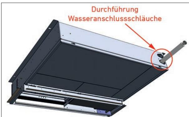
Für die Montage des Gerätekörpers in der abgehängten Decke ist in dieser ein Ausschnitt mit den Abmessungen 1140 x 278 mm vorzusehen. Die Längsseite verläuft dabei parallel zur Fassade.
